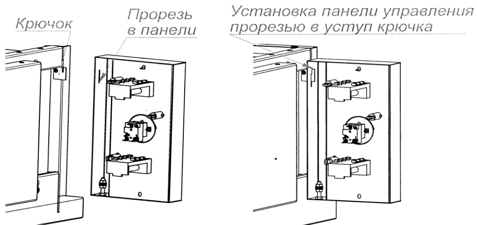
Рис. 8 СХЕМА УСТАНОВКИ ПАНЕЛИ УПРАВЛЕНИЯ ПРИ ТО
